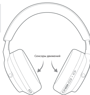
Diagram 3 Расположение сенсоров приближения
