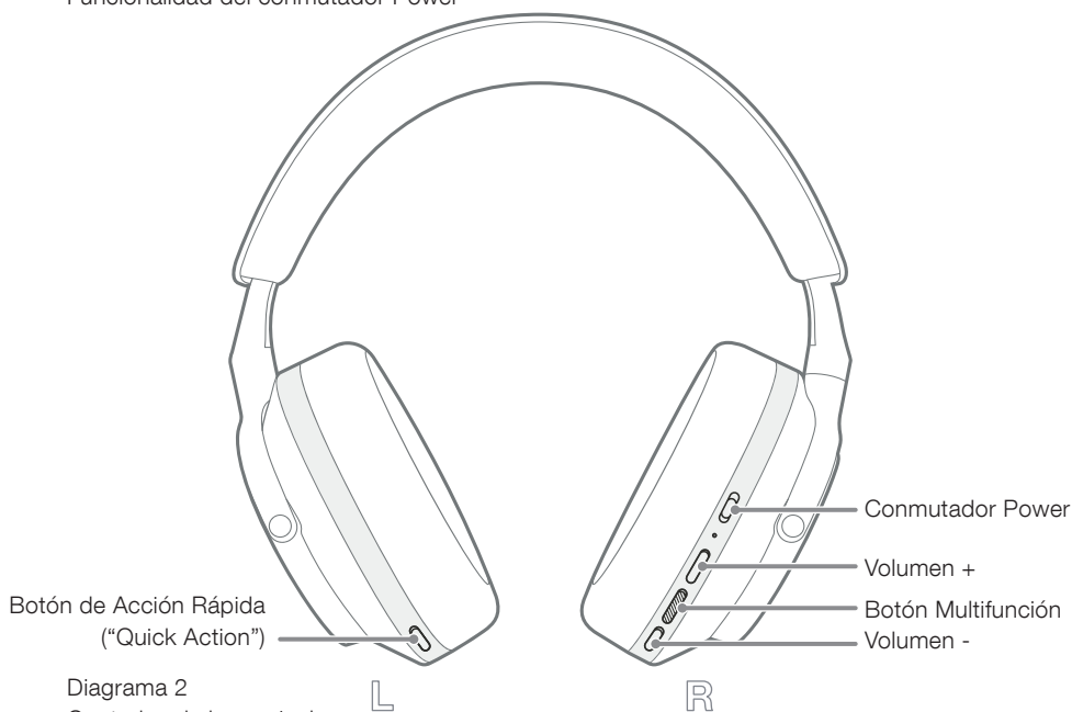
Diagrama 1 Funcionalidad del conmutador Power
